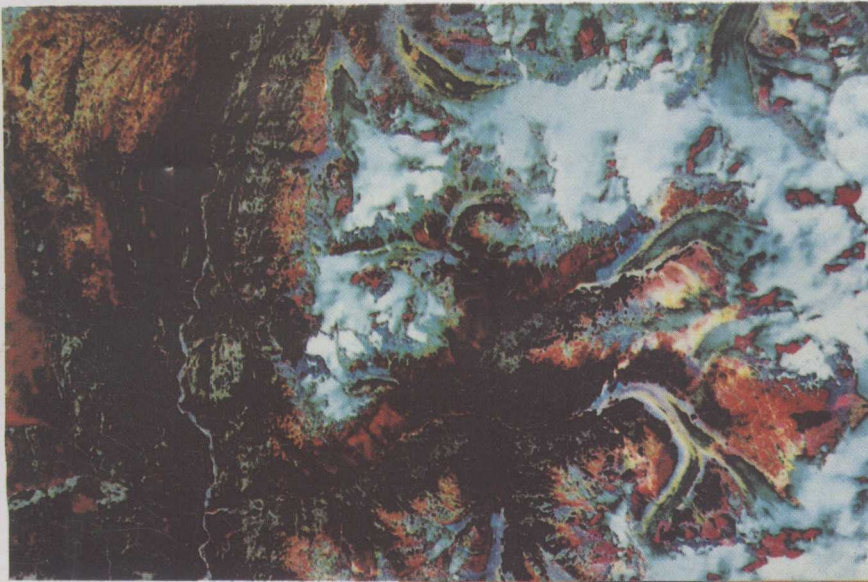
图2 PC5 填出所有含金硅化、绢云岩化蚀变岩(黄色), PC3填出与成矿有关二长岩(蓝色)
