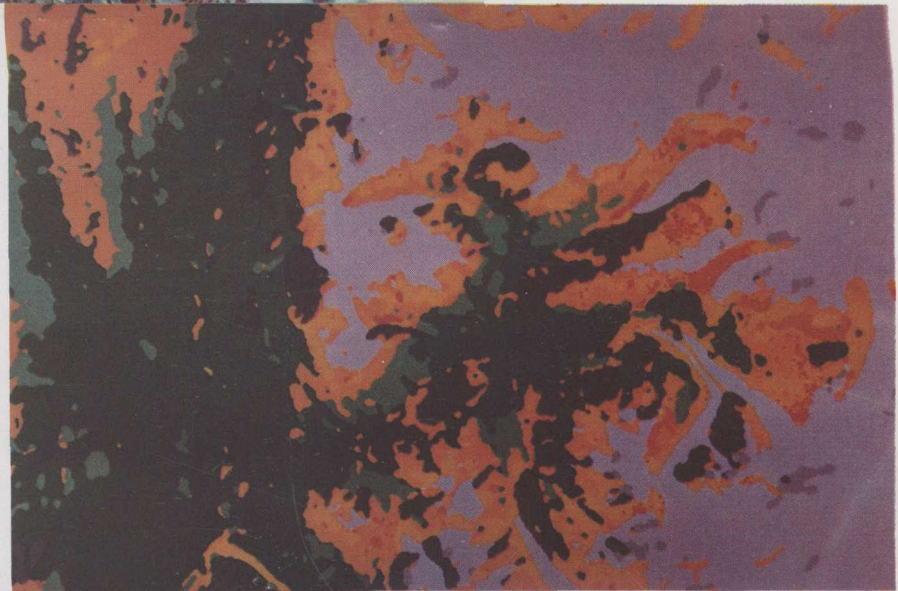
图3 采用非监督分类方法提取PC5中全部已知蚀变岩信息并且发现2处新区
